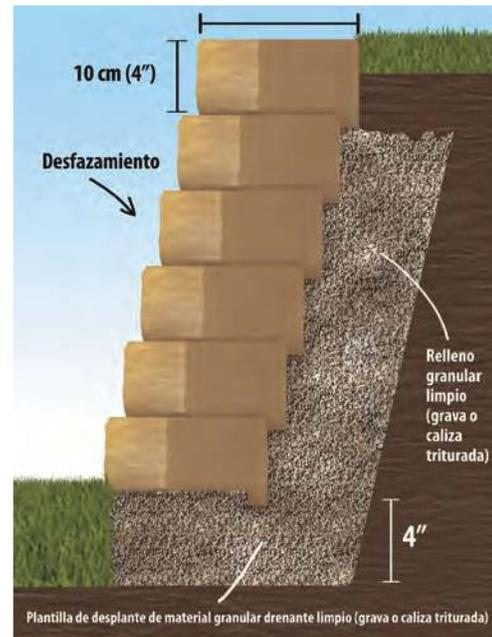
Como se muestra en la figura, se recomienda el uso de grava de 1/2 " a 3/4" para rellenar la parte trasera del muro con la finalidad de drenar y prevenir que haya pérdida de tierra a través del muro.
