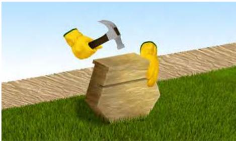
Con Garden Wall usted puede construir curvas tan pequeñas como de 66cm de radio para mantener un espaciado uniforme. Rompa la pestaña exterior de la pieza o ranura de retención, sosteniéndola firmemente y luego con la ayuda de un martillo golpee.
