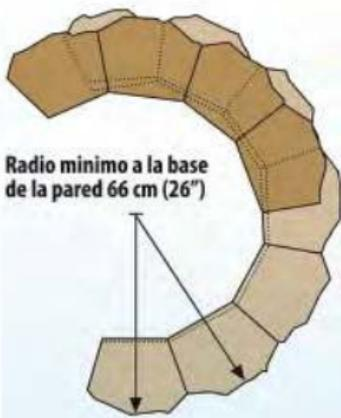
Con Garden Wall se pueden construir curvas desde 66 cm (26") de radio. Para mantener mayor espaciamiento, sólo rompa las pestañas o bordes exteriores del labio retenedor como se muestra arriba.
